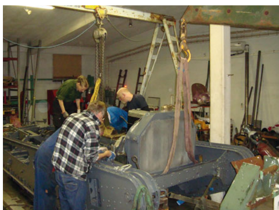
Den nyrenoverade motorn monteras på plats i Sveriges första stridsvagn.
