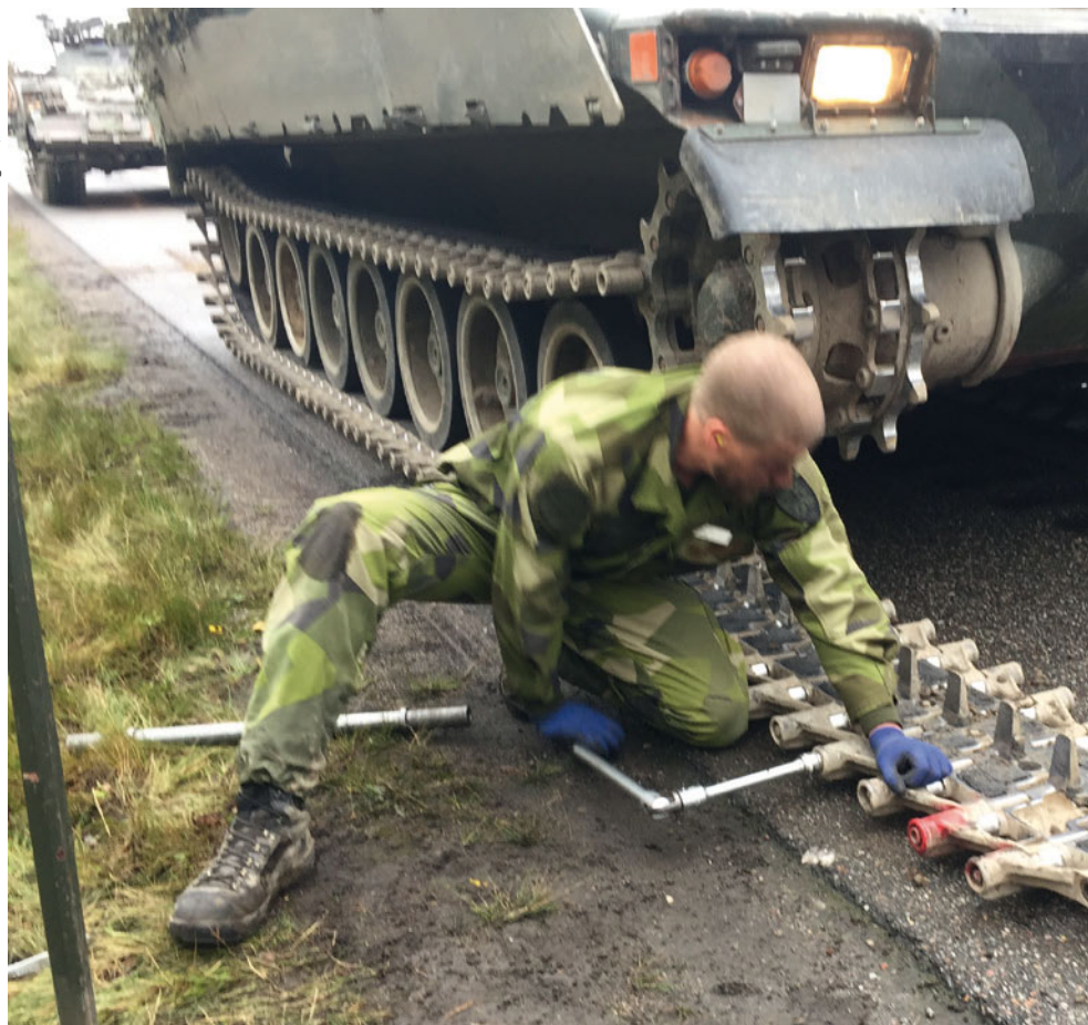
Byte bandplattor och bärhjul Strf 90 på E18 under Aurora 17.
