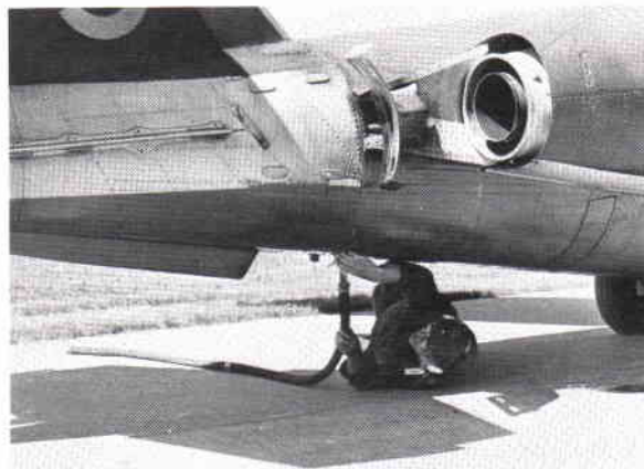
En dränerslang måste monteras – och då blåser det varmt, för motorerna måste vara igång.
