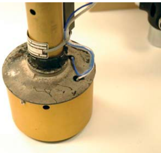
Beläggning, orsakad av mikroorganismer, på en nivågivare i drivmedelstanken på ett transportflygplan.
