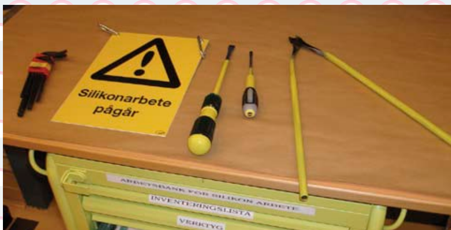
Bild 1. Bra uppmärkta verktyg och varningsskylt, FMLOG Flygverkstan i Sätenäs. Foto: Flygverkstad Sätenäs.
