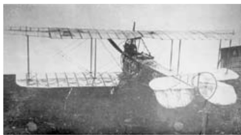
Aviatik C I nr 826/16 i fuktig väderlek. Lägg märke till den skrynkliga vingklädseln.
