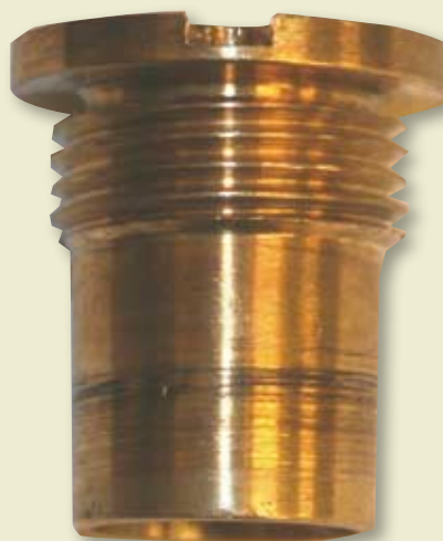
Tändskruv M/51C efter rengöring.
