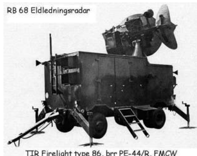
Bild 3. RB 68 eldledningsradar, brr PE-44/R (TIR Firelight type 86). FMCV-radar.
