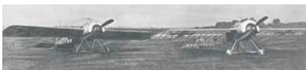
En "genomskinlig" och en dukklädd Fokker E III sida vid sida på marken.
