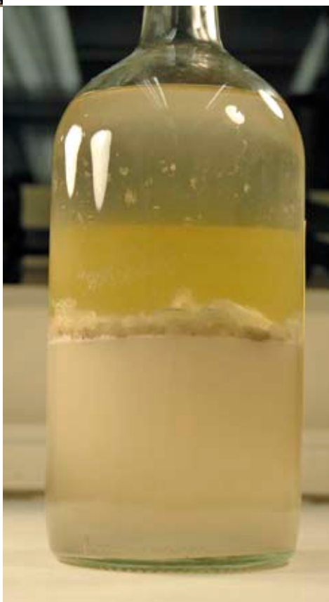
Kontaminerat drivmedelsprov från en drivmedelsanläggning på ett av Försvarmaktens flygfält.
