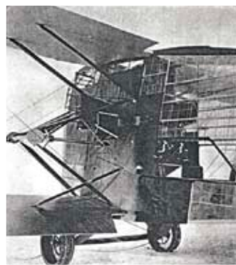
I denna närbild kan man skymta motorerna inne i "maskin- rummet" och axeln som via en vinkelväxel driver propellern.
