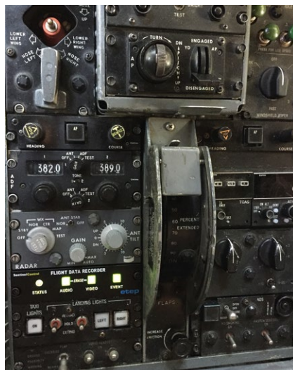
På instrumentpanelen finns reglage för CVR/FDR systemet.
