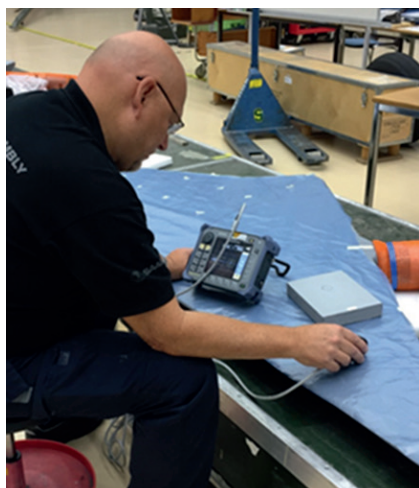
Skadeundersökning med resonansteknik.
