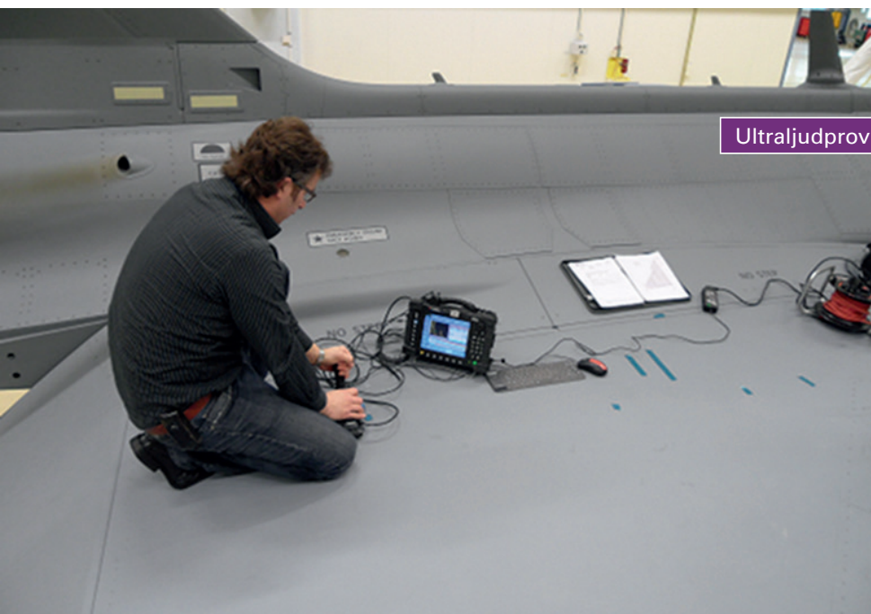
Skanning med ultraljud på komposit med syfte att finna defekter.
