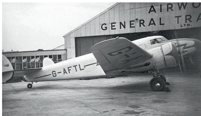
Bild 6. Cottons Lockheed 12A, G-AFTL. "Bubbelfönstret" som gör det möjligt för piloten att se nedåt och som använts i otaliga andra flygplanstyper sedan dess uppfanns också av Cotton, just för G-AFTL. Ett lodkamerasikte i ett affärsflygplan kunde ju verka litet misstänkt...
