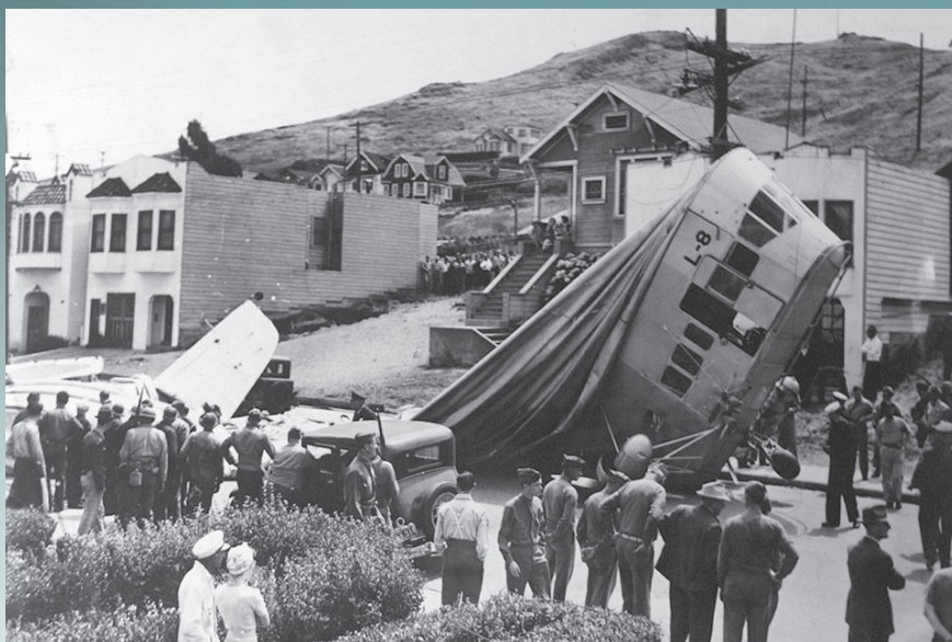
Bild 5. Gondolens högersida efter landningen. På denna bild syns den upphakade dörren tydligt, liksom bombstället där den lossnade sjunkbomben satt.
