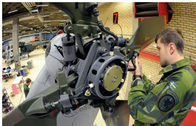
En helikoptertekniker på 1. hkpskv utför modifiering av avisningssystemet.
