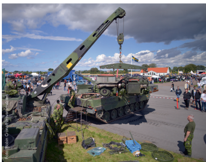
Motorentusiasterna var på helspänn då motorbytet gjordes på Stridsvagn 122 med hjälp av Bärgningsbandvagn 120.
