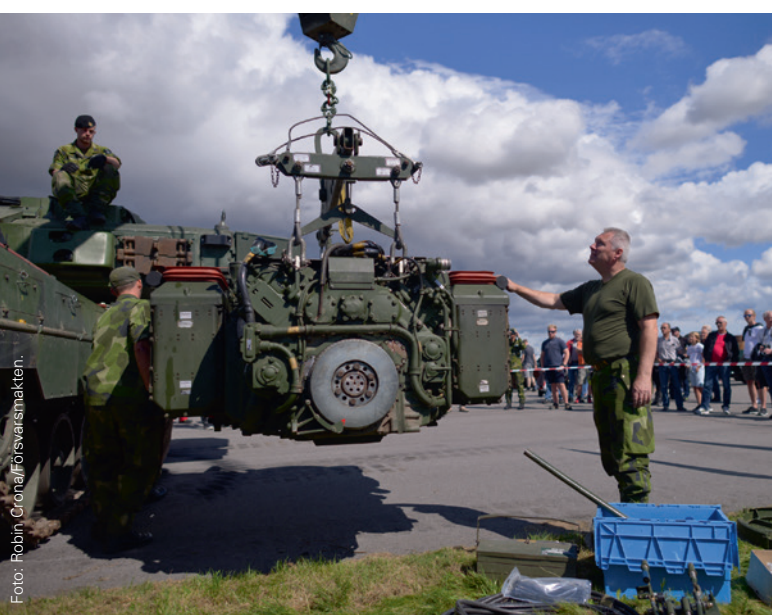
Motorentusiasterna var på helspänn då motorbytet gjordes på Stridsvagn 122 med hjälp av Bärgningsbandvagn 120.
