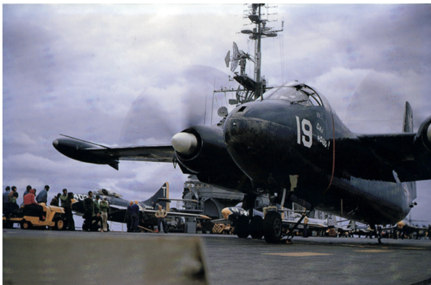
Bild 3. En AJ-2 klar för katapultstart ombord på USS Midway 1955. Den mörkblå färgen var standard inom US Navy vid denna tid. Den öppna huven var också standard vid start och landning på hangarfartyg för att underlätta snabb evakuering om man hamnade i vattnet.
