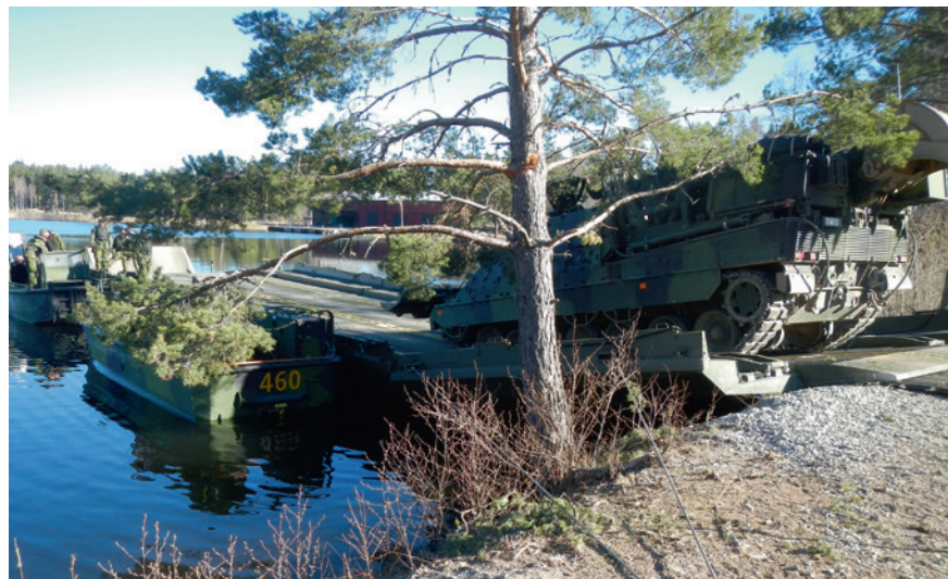
Trafikering DB 300 färja med Ingbov 120 från hög strandbrink.
