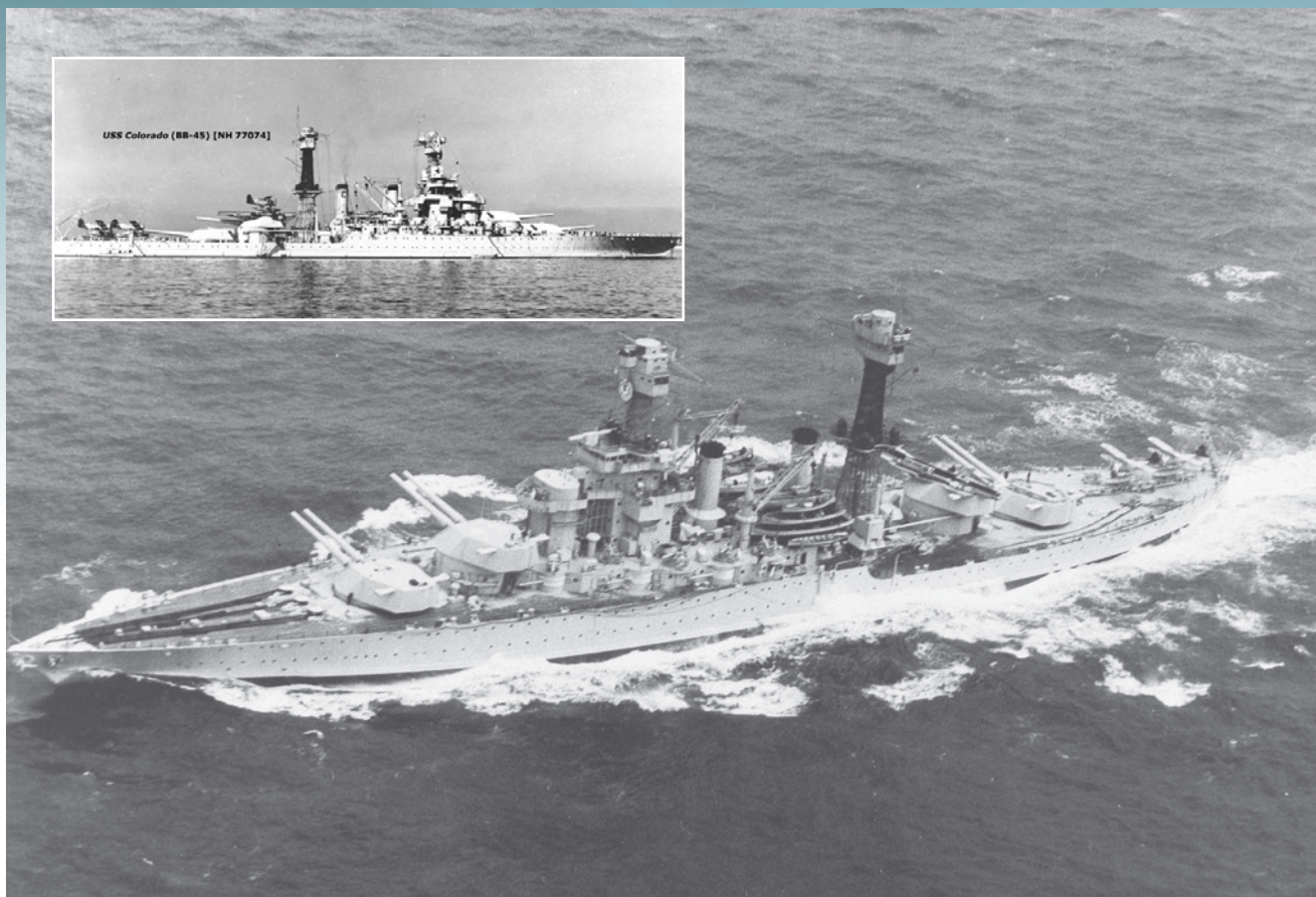
Bild 2. Slagskeppet Colorado (BB 45) på 1930-talet. Lägg märke till det udda arrangemanget med flygplankatapulten placerad ovanpå ett av de akre kanontornen.
