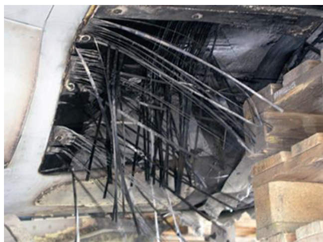
Bild 5-6. Fiberklasar efter en tidigare brandincident på fpl 39. Foto: Ola Bengtsson, F 17
