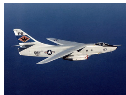
Bild 4. En Skywarrior från USS Constellation fotograferad över Syd kinesiska sjön 1974. I detta fall rör det sig om ett motmedelsflygplan, EA-3B, vilket framgår av de två fönstren i flygkroppen framför vingroten.
