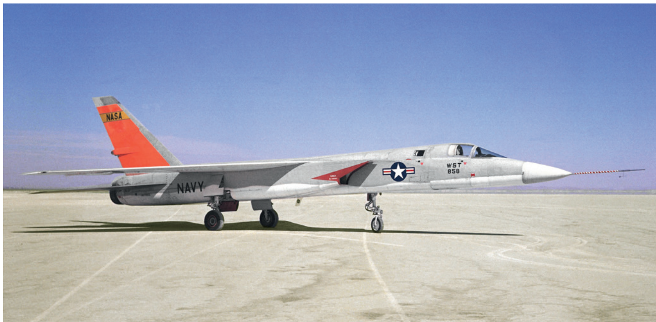
Bild 5. En A3J-1 (=A-5A) Vigilante under typutprovning vid Patuxent River 1962. Just detta exemplar användes av NASA för prov i samband med de amerikanska planerna att bygga passagerarflygplan med överljudsfart, därav märkningen på fenan.
