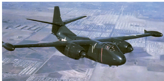
Bild 2. AJ-1 Savage med den ursprungliga stjärtkonstruktionen.
