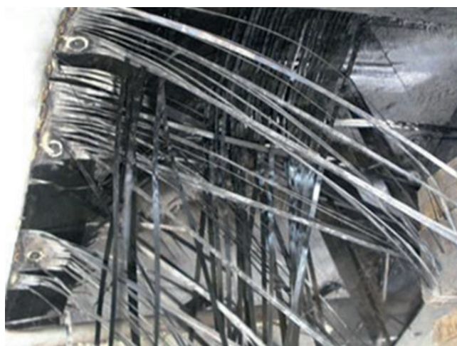
Bild 5-6. Fiberklasar efter en tidigare brandincident på fpl 39. Foto: Ola Bengtsson, F 17
