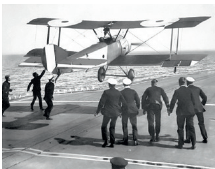
Bild 5. Squadron Commander Denning gör den första landningen någonsin på ett fartyg under gång med en Sopwith Pup den 2 augusti 1917. Notera de "manuella bromsvajrarna" och "handtagen" under kropp och vingar.
