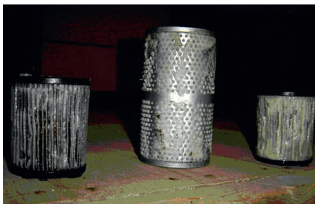
Figur 3. Filter igensatta med vaxutfällning (paraffiner).
