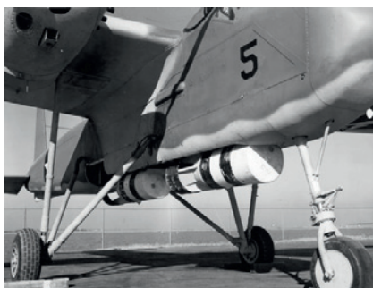
Bild 4. Ett udda vapenalternativ på en TDN-1, två sjunkbomber. Det måste ha funnits tankar om att använda drönare även för ubåtsjakt.
