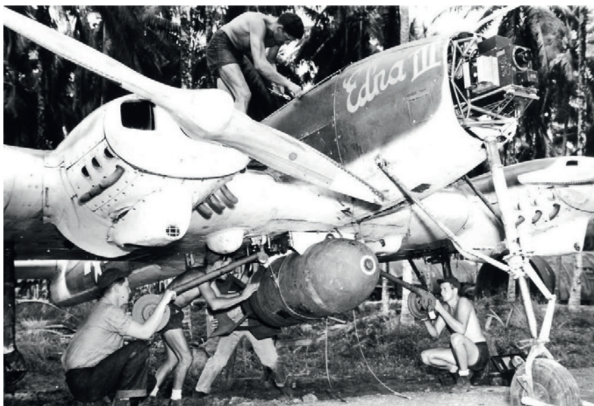
Bild 7. En TDR-1 under klargöring på Russellöarna. Lägg märke till TV-kameran i nosen och de två flygteknikerna med "spinnspön" som håller på att hänga en 907 kg bomb.
