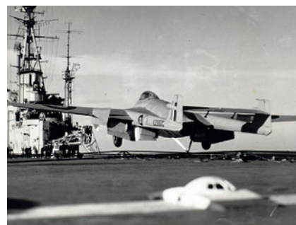
Bild 4. Den första landningen med ett jetflygplan på ett hangarfartyg, Sea Vampire Mk 10 LZ 551 landar på HMS Ocean, 3 december 1945. Bilden är tagen just som flygplanets krok har fastnat i bromsvajern.
