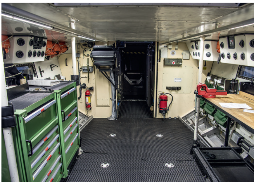
Inredning för en driftstödsgrupp monterad i en stridsbåt 90.
