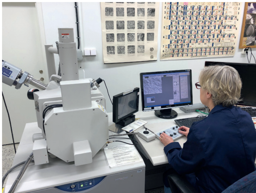
Bild 7. Utredningsledare Gunilla Helmersson undersöker brottytan i svepelektronmikroskop.
