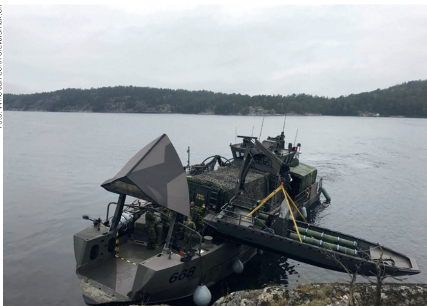
Delar av reparationspluton genomför lyft och reparation av en gruppboat (G-båt).
