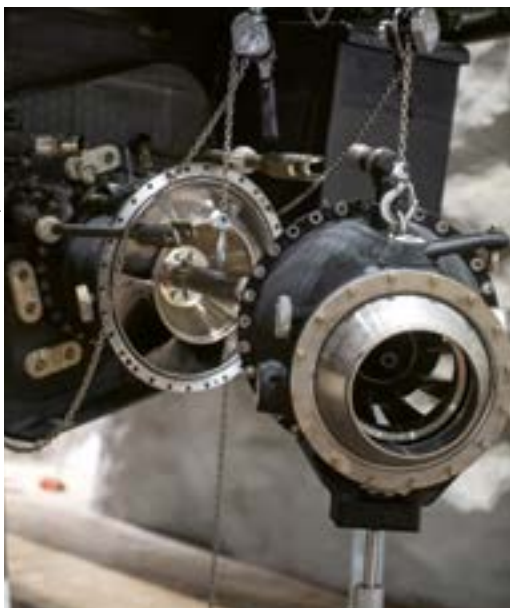
Placeringen av impeller i aggregatet på Strb90.
