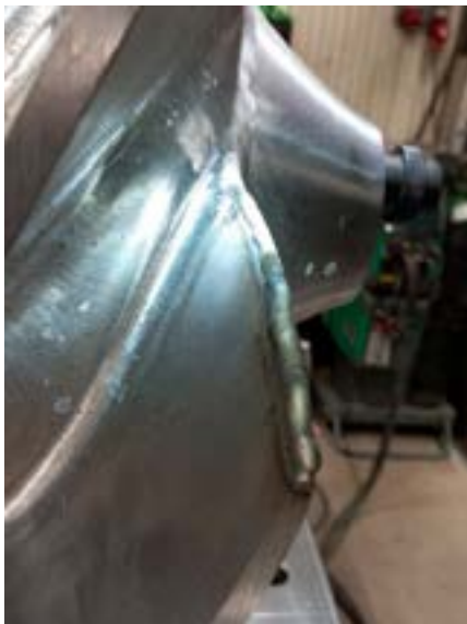
Ny metall på plats på framkanten av bladet.
