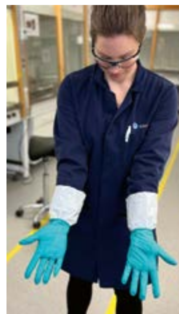
Figur 4: Operatören tar på sig polymerlaminathandskar och nitrilhandskar utanpå. Nitrilhandsken ger bättre fingertoppskänsla och kan bytas om man spiller på dem.
