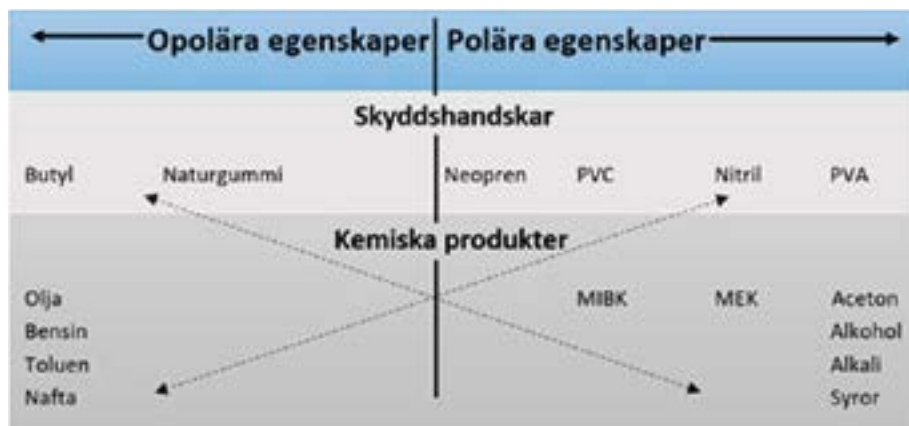
Figur 2: Val av handskmaterial utifrån produktens kemiska egenskaper (polaritet).
