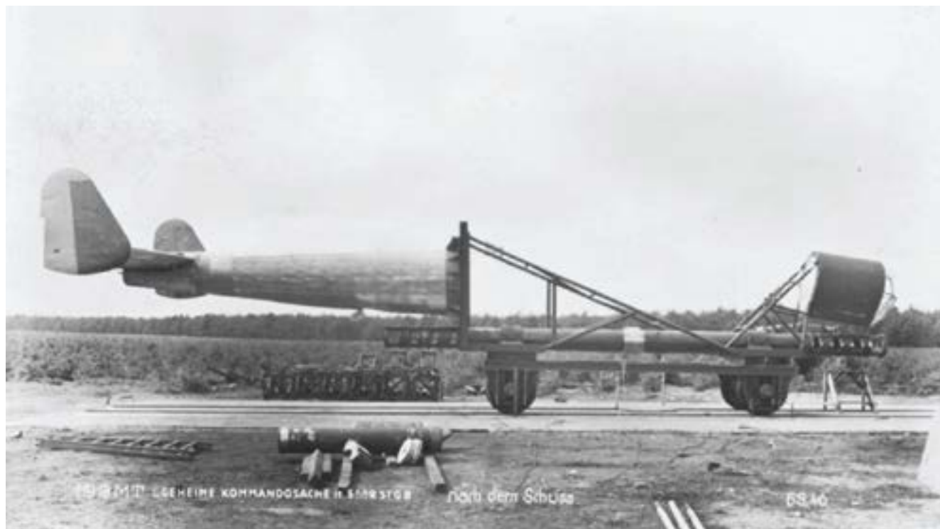
Bild 1. Sondergerät SG-104 "Münchhausen." Mock-up av installation under ett Do 217 bombplan. Vapnet var avsett för pansarskyddade sjömål, men det visade sig att tryckvågen bakom vapnet var så kraftig att flygplanets stjärt skadades varför det aldrig kom till insats. Den grövsta kaliber som någonsin faktiskt använts i ett fpl är 105 mm.
