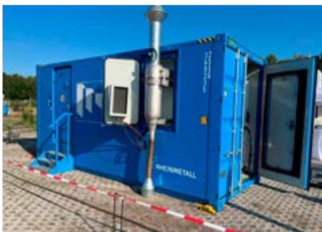
Rheinmetall mobile factory med WAAM skrivare, tillverkar metallstycken upp till 80 kg som sedan CNC fräses i samma maskin.
