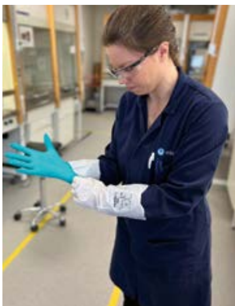
Figur 4: Operatören tar på sig polymerlaminathandskar och nitrilhandskar utanpå. Nitrilhandsken ger bättre fingertoppskänsla och kan bytas om man spiller på dem.
