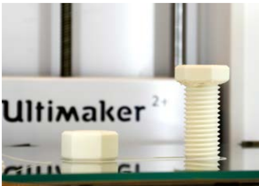
Bult med passande mutter nyss utskrivna i 3D-printer.
