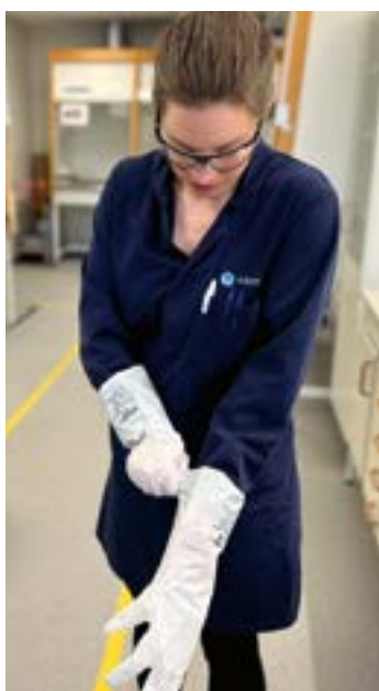
Figur 4: Operatören tar på sig polymerlaminathandskar och nitrilhandskar utanpå. Nitrilhandsken ger bättre fingertoppskänsla och kan bytas om man spiller på dem.
