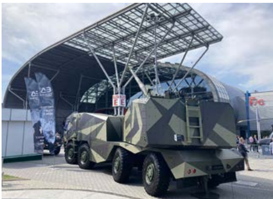
Morana, ett Tjeckiskt 155 mm självgående artillerisystem baserat på ett Tatra 8x8 chassi.
