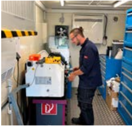
Efterbearbetning av 3D-printade detaljer med svarv i 20 fot-container, belgiska armén.
