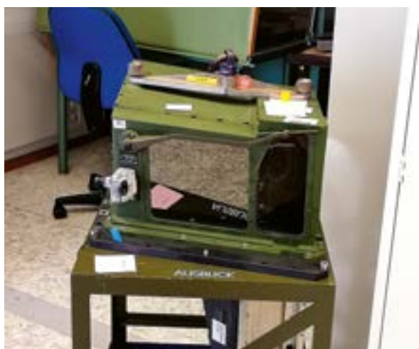
Ett av de lasrar som testas på laserbanan – lasern i Skyttens Sikte, Strv 122.
