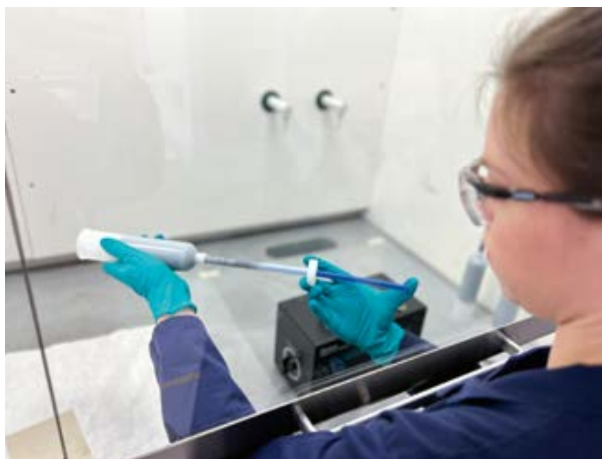
Figur 3: Ett semkit är fördelaktigt då bas och härdare är uppvägda på förhand. Operatören injicerar härdaren i basen och risken för kontakt med de två komponenterna är mycket liten. Arbetet sker i dragskåp och operatören bär labbrock, skyddsglasögon och nitrilhandskar.
