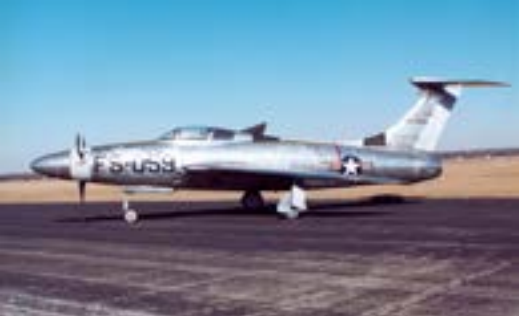
Bild 2. Den första prototypen på marken. Bilden är troligen tagen vid det amerikanska Flygvapenmuseet. Lägga märke till den snedställda "anti-torque"-fenan bakom förarutrymmet.
