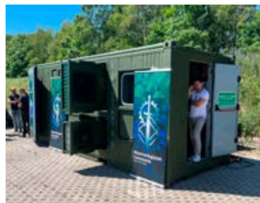
AM Container Nederländerna senaste utveckling av en AM container med utfällbar klimatanläggning för att ge optimal temperatur vid utskrifter.
