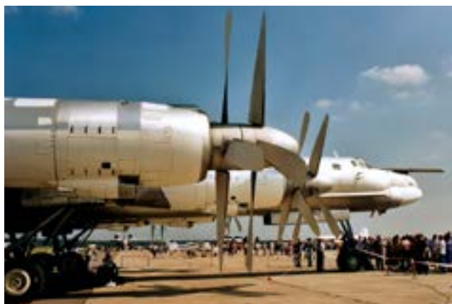
Bild 4. Tu-95, propellerbladen är kraftigt torderade så att anfallsvinkeln på bladspetsen som kan komma upp i överljudsfart blir liten, och bladspetsen är också mycket tunn.
