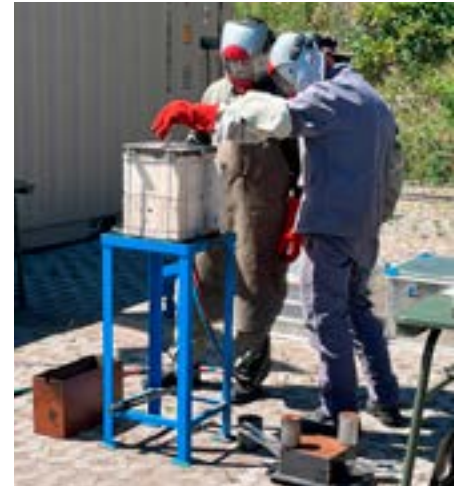
Österrikiska arméns tekniska skola förevisade gjutning av reservdelar som tillverkas från tillgängligt aluminiumskrot.
