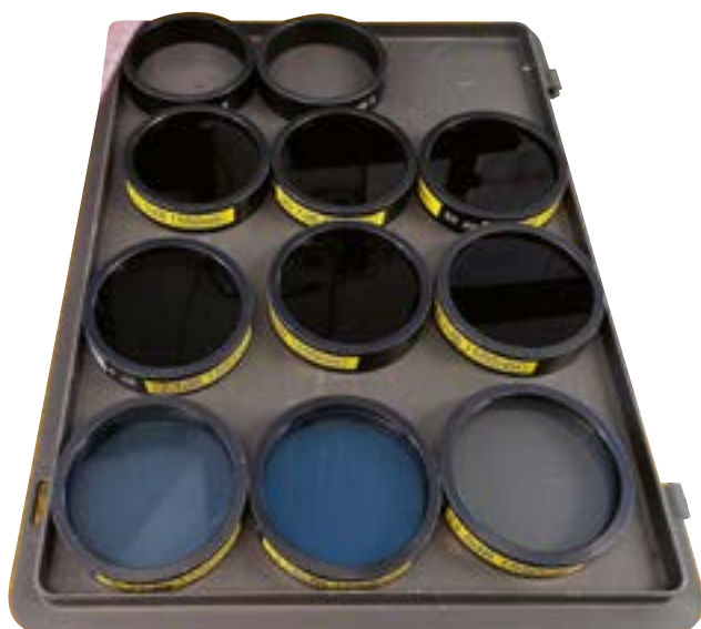
Dämpningsfilter – används främst för mätning av utsläckningsdämpning av lasrar.
