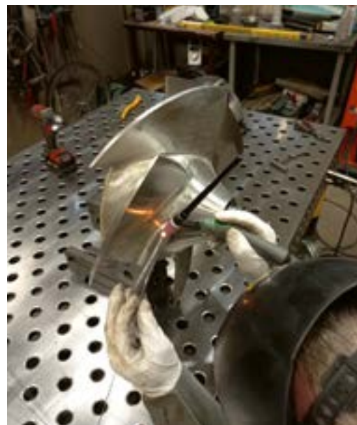
Starten med TIG-svetsen tillförsel av nytt material.
