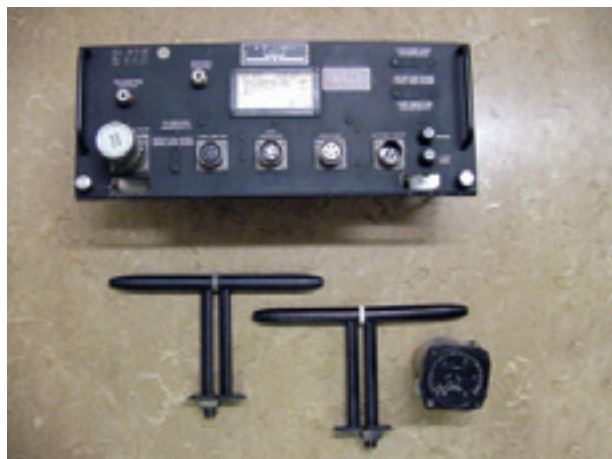
Radarhöjdmätare AN/APN-1 (svensk beteckning PH-10/A) med instrument och "cigarrantenner". Denna typ av höjdmätare anskaffades tidigt på 1940-talet och kan ha varit den utrustning som användes vid de första radarförsöken på Bromma.
