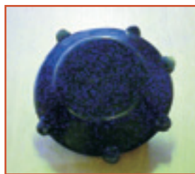
Återvunna kolfibrer från havererad JAS 39 Gripen. Återanvända som förstärkningsmaterial till en motorcykelkåpa.
