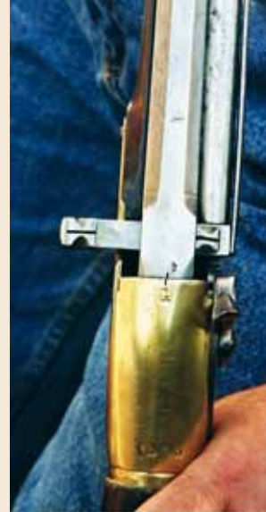
Bild 5. Mekanismen uppi- från. I mitten laddhandtaget som drögs till vänster för laddning. På högra sidan av pipan syns rännan där magasinet monteras.
