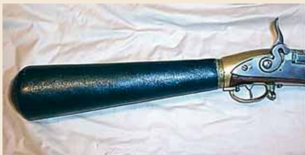
Bild 2. Luftflaskan/kolven och fattningen där den skruvades fast på geväret. Lägg märke till att hanen är utformad efter mönster från ett flintlåsgevär, men utan flinta!
