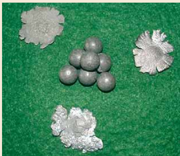
Bild 3. Blykulor före och efter skjutprov mot en stålplåt.
