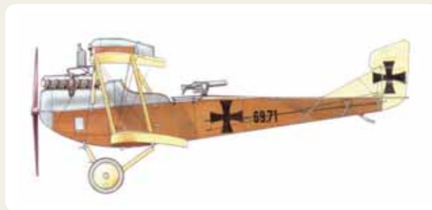
Hansa-Brandenburg C.I med "babykorg" över vingen, ett osynkroniserat MG som sköt över propellern.
