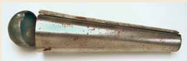
Bild 4. Luftflaskan löddes ihop av två järnplåtar. Att få flaskan tät och hållfast med 1700-talsteknik kan inte ha varit lätt.
