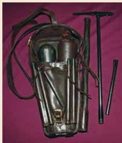
Bild 6. Den enda bevarade tillbehörssatsen till ett Girandoni-gevär. Två luftflaskor, tre magasin, en handpump (med kombinerat universalverktyg/fotplatta) och laddapparat längst till höger.
