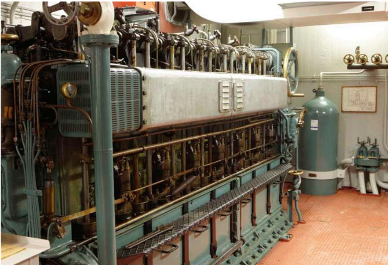
En av två Kockum-M.A.N. dieslar från ubåten Nordkaparen (1935-1953). Delfinen II-klass, reservkraft för avmagnetisering.
