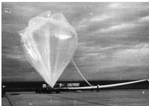
En WS-119L ballong tankas med vätgas före start. Ballonghöljet matas samtidigt successivt över en rulle på bilen under ballongen och när hela ballongen är fylld stiger den med sin last. Foto: Robert Burch.
