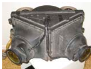
Specialutvecklad snedbildskamera med 2 objektiv. >>>
