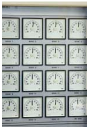
Magnetometer med 15 kanaler plus jordfältskompensering.
