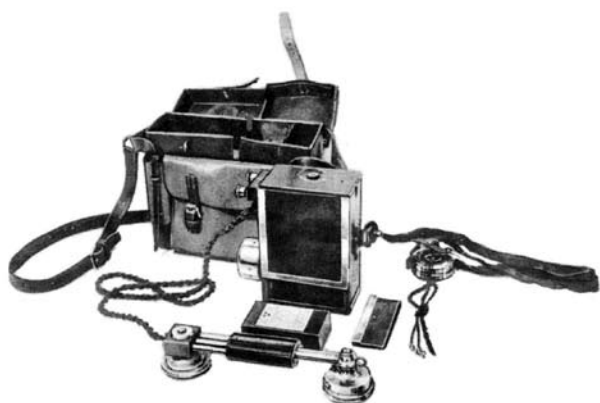
Telefonapparat m/09 Tc 90190. Längd 210 mm, bred 75 mm, höjd 160 mm.
