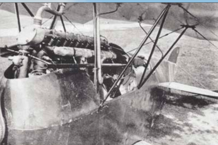
Fronten på prototypen 20.23. Maskingevären i ögonhöjd hade eldrören fixerade vid luftintaget och kamaxelkåpan.
