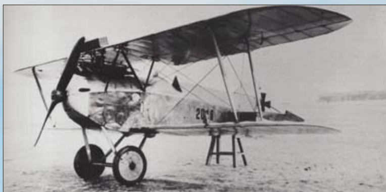
Prototypen 20.18 (som sedan blev (D.II) 322.09 – som sedan blev (D.III) J32!). Man kan se öppningen för maskingeväret vid propelleraxeln och det balanserade höjdrodret med ett horn som sticker upp i kanten.
