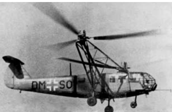
Bild 6. Serieutförandet Fa 223E-0. Kulspruteringen i nosen är tydligt synlig. De båda mörka "banden" runt mittkroppen är kylflötsintaget respektive – utloppet för motorn.
