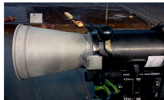
M4-slutstycket monterat på granatgevär Carl-Gustaf (Saab AB affärsområde Dynamics).
