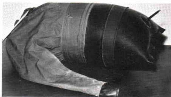
Fixturblåsa för reparation av isolerdräkt
